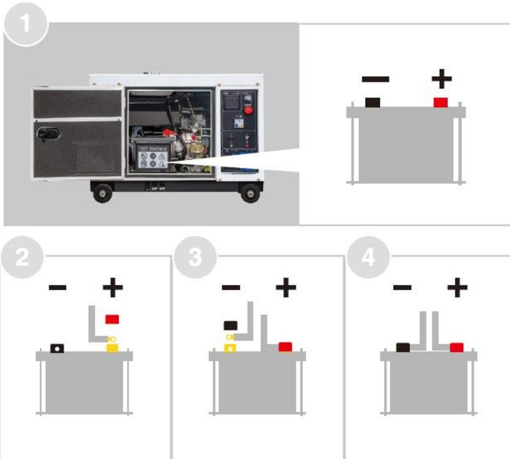
**⚠️ WARNUNG** Die Batterie wird beim Betrieb des Generators automatisch geladen. Trennen Sie die Batterie niemals vom Generator ab, wenn dieser eingeschaltet ist. Dies kann zum Kurzschluss und Beschädigung des Generators führen, wie auch einen Brand oder Stromschlag verursachen.
