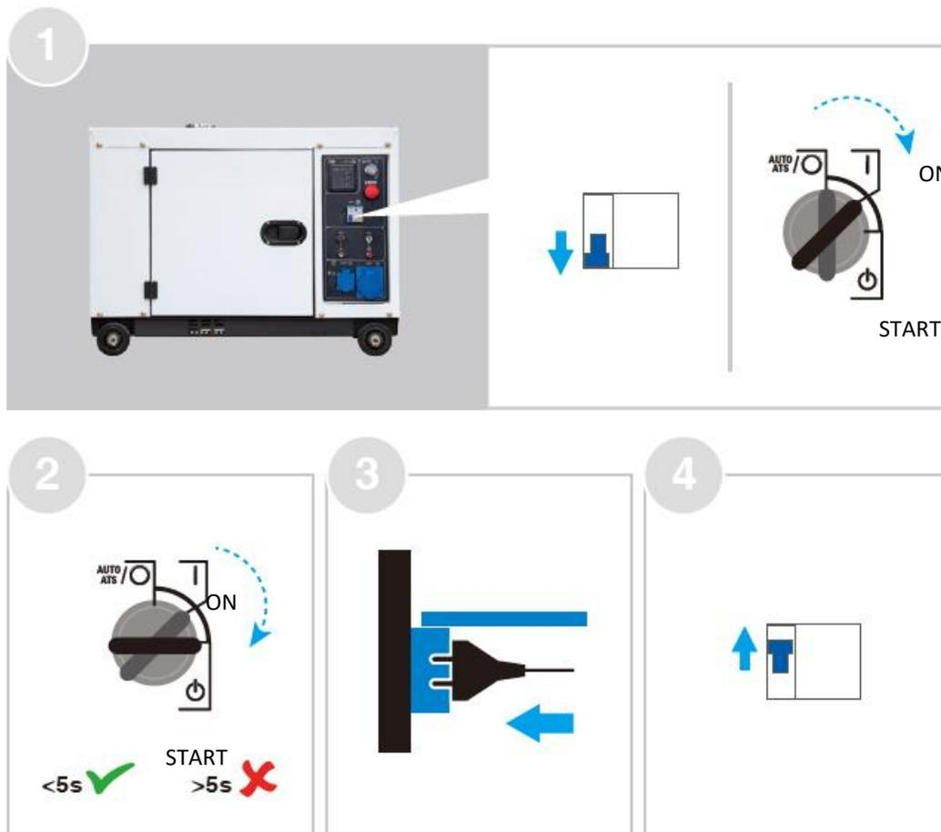
**⚠ ACHTUNG** Die Nennleistung des Generators muss höher sein als die Gesamtleistung aller angeschlossenen Verbraucher. **Beachten Sie, dass die Leistungsaufnahme beim Start einiger Verbraucher das 3-5 fache der angegebenen Nennleistung betragen kann!**
