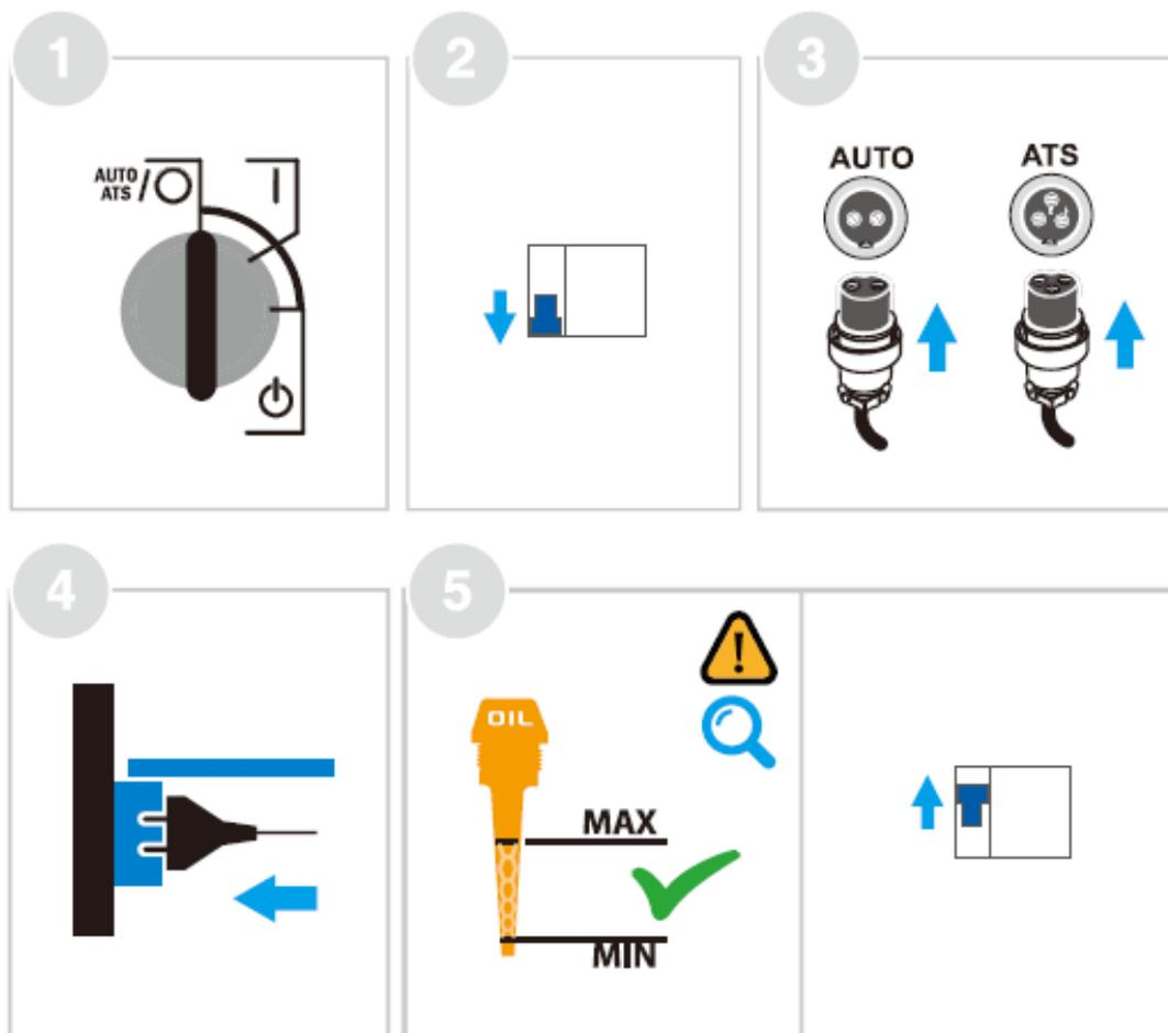
**⚠ ACHTUNG** Kontrollieren Sie regelmäßig den Ölstand. Mit einem geringen Ölstand wird der Generator nicht gestartet. **Wenn das Gerät nicht täglich betrieben wird, sollte es in regelmäßigen Abständen für 20-30 Minuten in Betrieb genommen werden. So stellen Sie sicher, dass das Gerät bei einem Bedarfsfall sofort einsatzfähig ist.**
